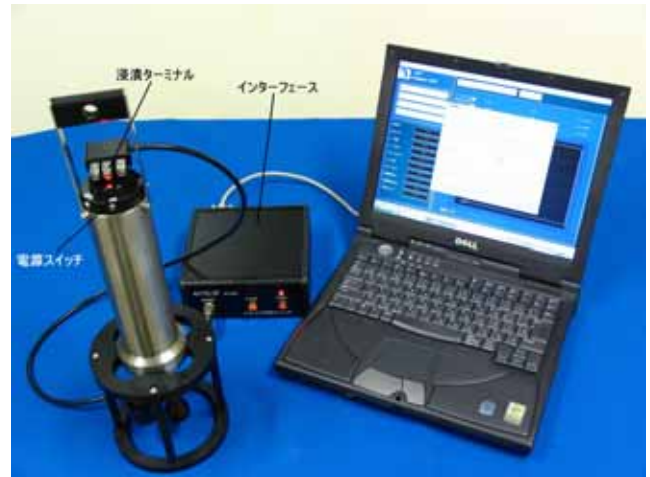
RS232C ケーブルで PC と接続された STD
